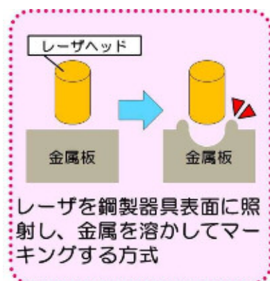
図 2. レーザ方式のマーキング機序
