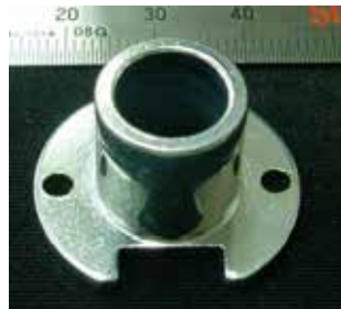
加工例3 材料:SPC 2.0t フランジ外径 \phi 27 mm 高さ 16 mm
