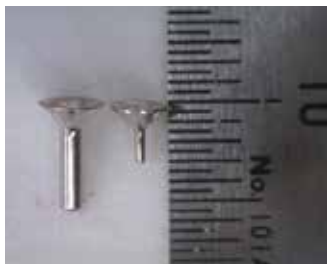
加工例2 材料:SUS304 t0.1 先端外径:左 \phi 1.1 mm 右: \phi 0.52 mm
